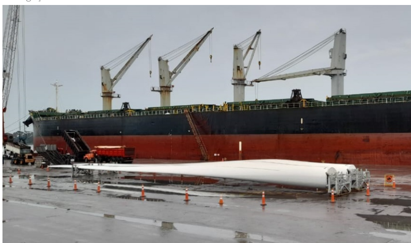
As pás, com 47 metros de comprimento e 8,6 toneladas cada uma, chegaram ao complexo no navio BBC Raise, vindo de Avilés, na Espanha
