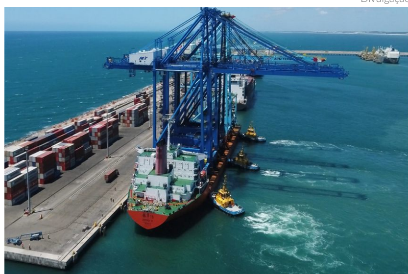
Dos novos equipamentos, três são guindastes RTG que movimentam contêineres em pátio; o outro é um portêiner STS que movimenta contêineres em navios
