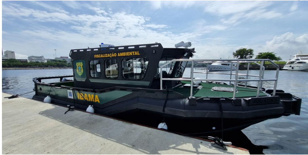
A DGS 999 tem comprimento total de 9,70 m, calado máximo com os motores trimados de 0,60 m, deslocamento máximo de 8 toneladas, e capacidade de carga de 2 toneladas
