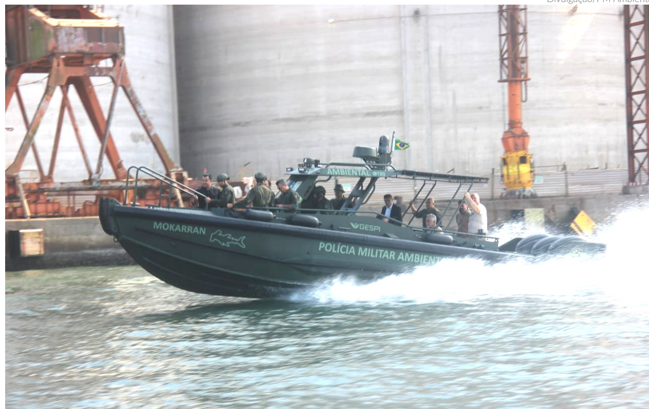
O barco Mokarran tem capacidade de mais de 2 toneladas de carga e conta com três motores de 300 hp, podendo atingir a velocidade máxima de 40 nós
