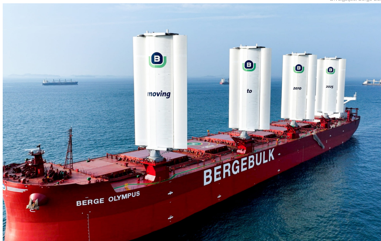
Com as velas rígidas, estima-se que o Berge Olympus poupe 6 toneladas de combustível por dia numa rota média mundial e reduza as emissões de CO2 em 19,5 toneladas por dia
