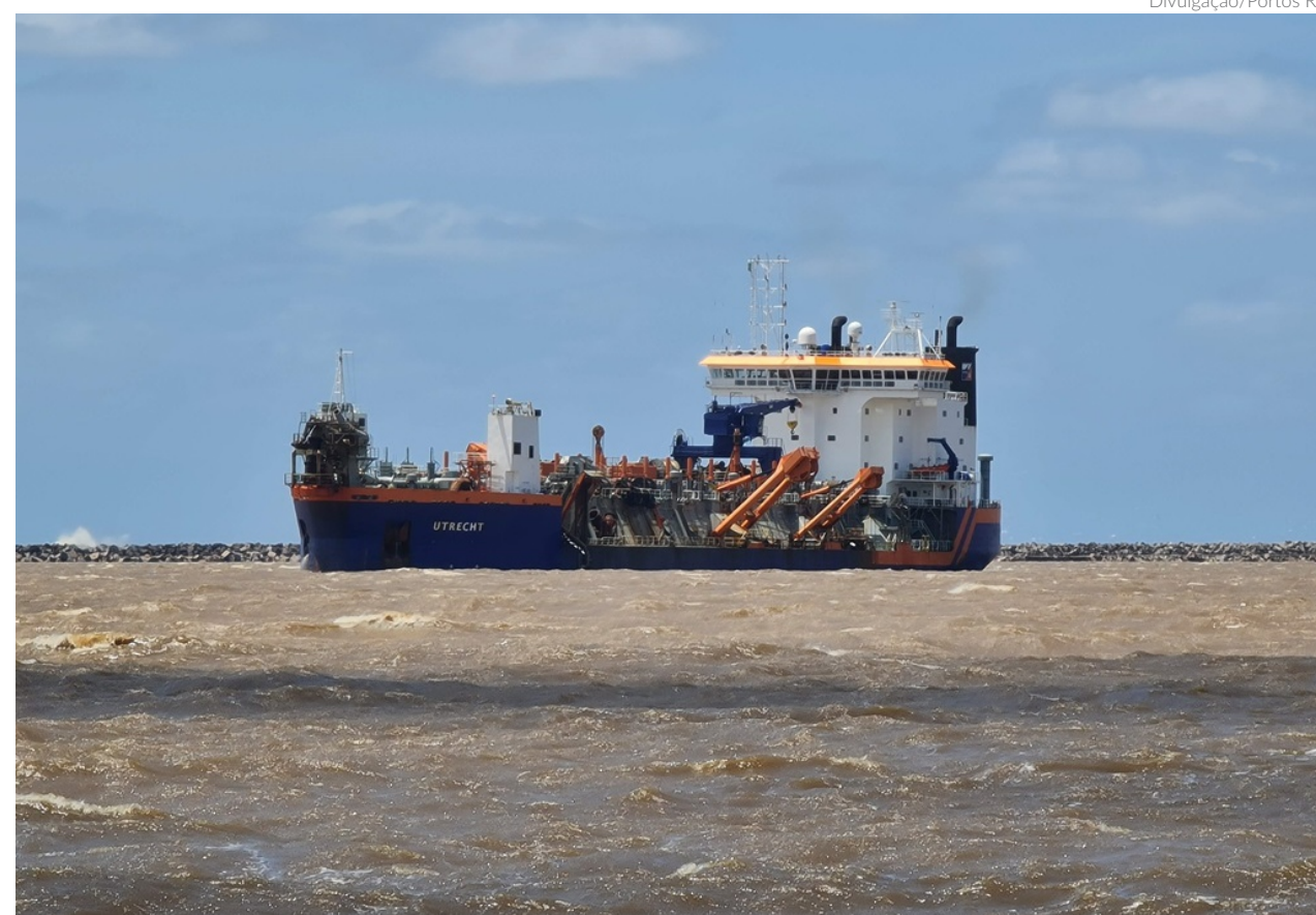
Até o momento, foram realizados em média nove ciclos de dragagem por dia, o que representa a retirada diária de cerca de 45 mil metros cúbicos de sedimentos
