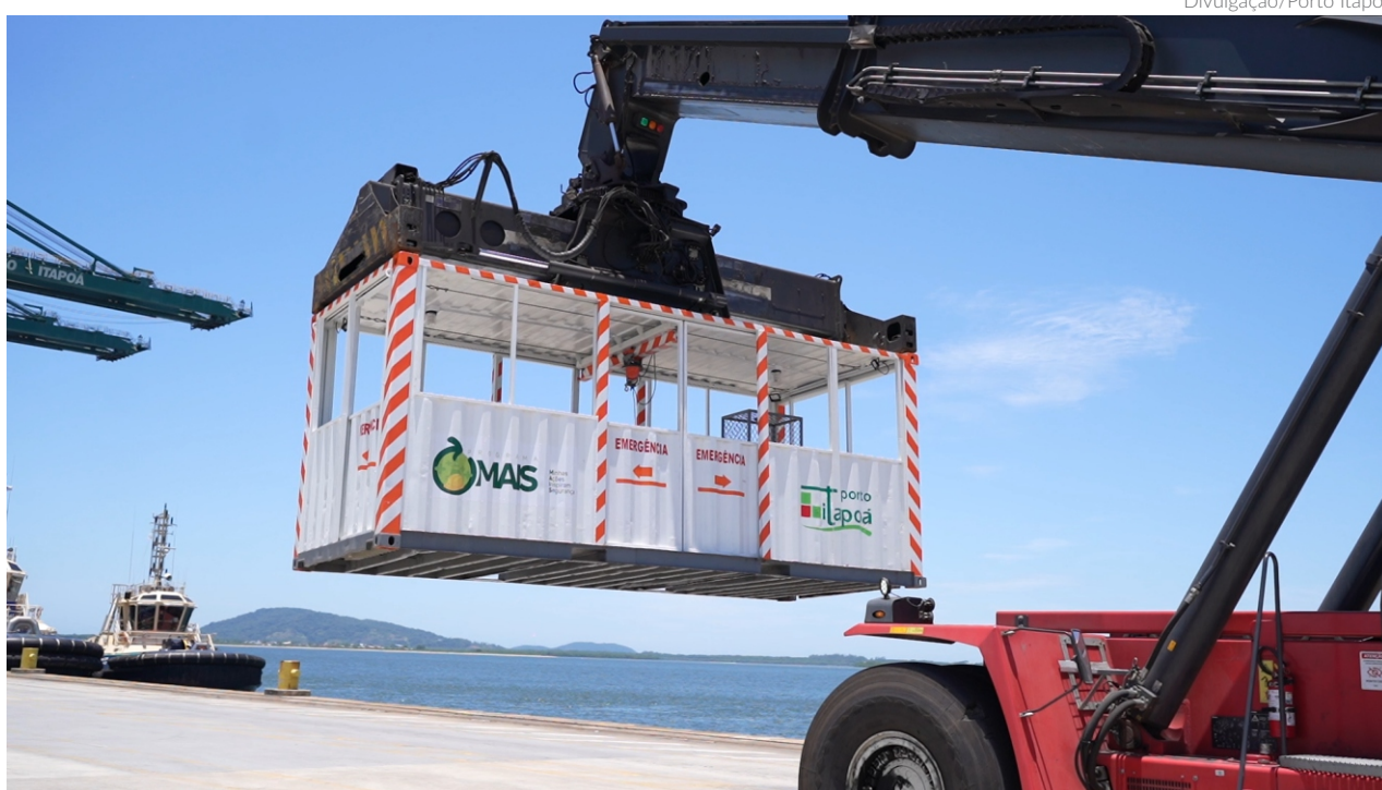
A gaiola se destaca por possuir quatro portas, uma característica planejada para otimizar as operações de salvamento em casos de emergência, garantindo eficiência e rapidez
