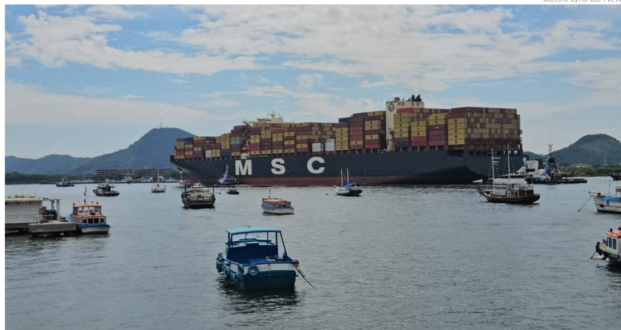
Construído em 2018, o MSC Natasha XIII tem, além dos 366 metros de comprimento, quase 50 metros de largura. Também possui capacidade para transportar até 14.432 TEU
