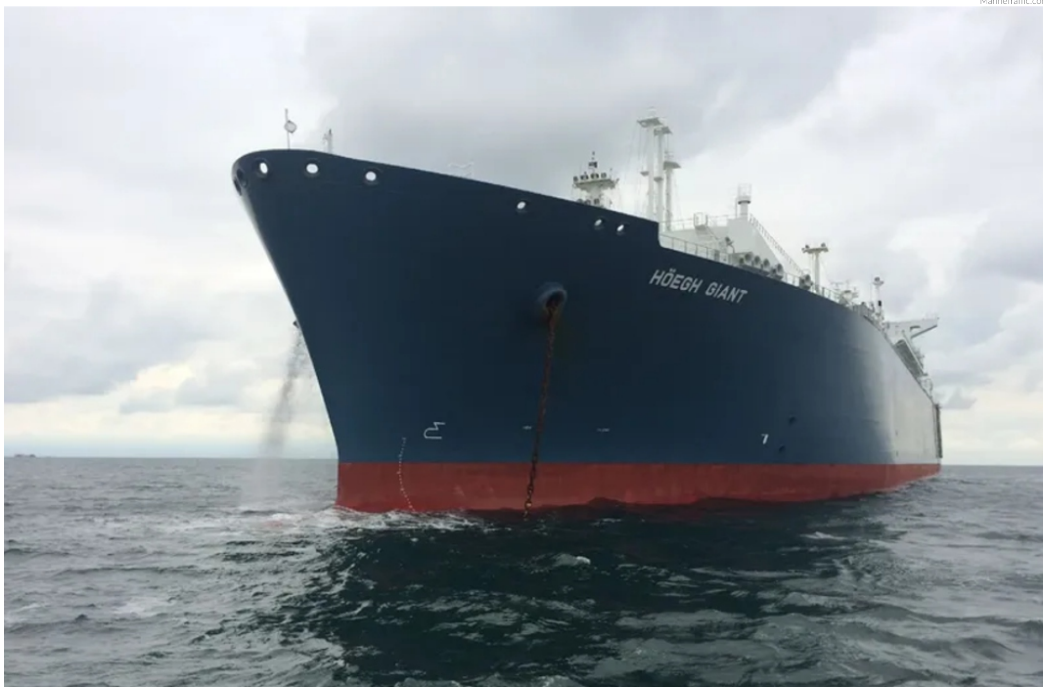
De bandeira de Singapura, o navio-tanque Höegh Giant veio da América Central para o litoral de São Paulo. Possui comprimento total de 294 metros e sua largura é de 46,04 metros
