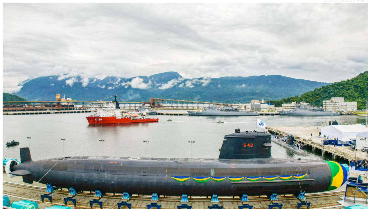
Após ser colocado na água, o submarino Tonelero vai dar início ao processo de testes para avaliar as condições de estabilidade no mar e os sistemas de navegação e de combate
