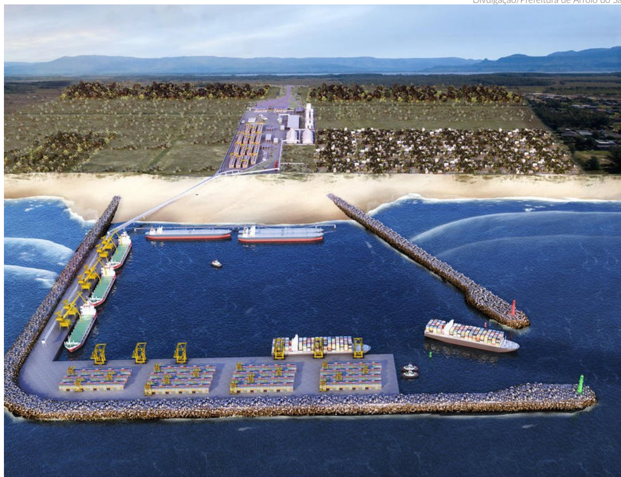
O projeto do Porto de Arroio do Sal contempla dez berços para atracação de grandes navios: oito para contêineres, granéis sólidos, líquidos e gás e dois para transatlânticos
