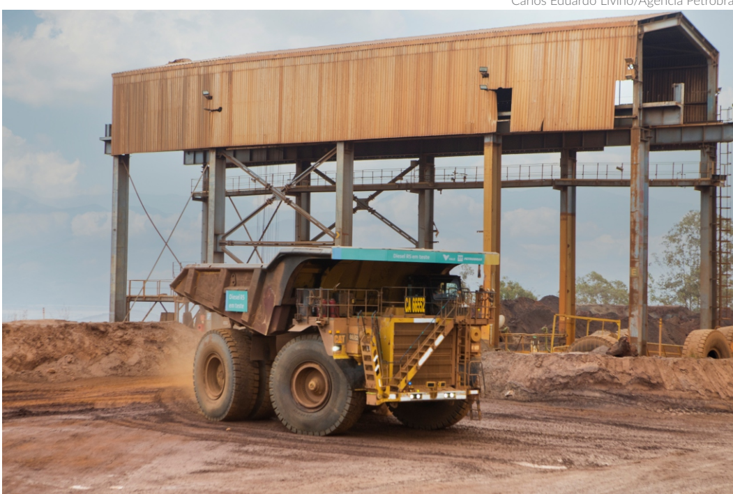
O combustível da estatal também é usado por um caminhão fora de estrada com capacidade para 214 toneladas, que atua na mina Fábrica Nova, no Complexo Mariana
