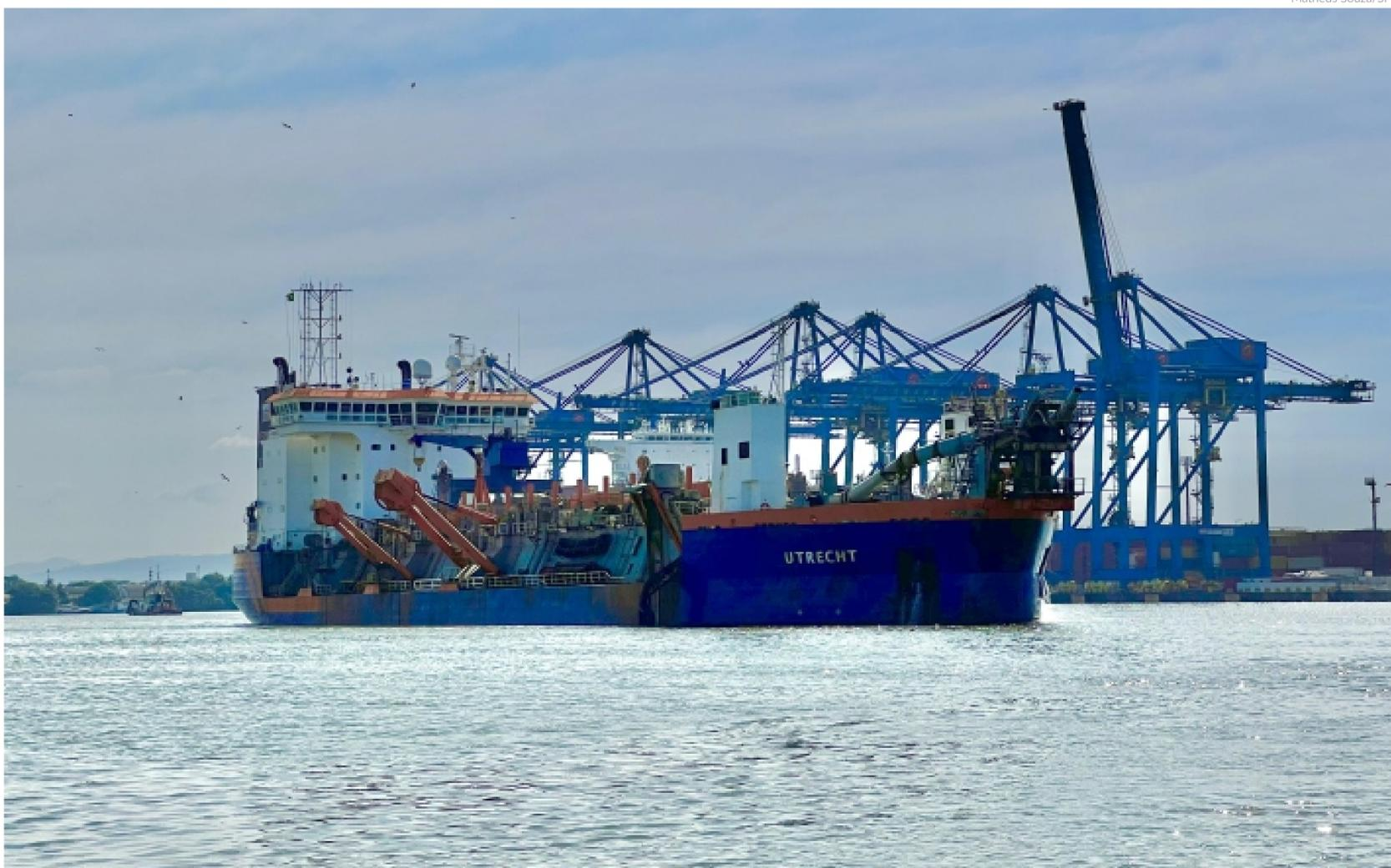
Projetada para serviços de dragagem intensivos e contínuos, a draga Utrecht possui um sistema de sucção que permite a coleta de sedimentos diretamente do fundo do canal
