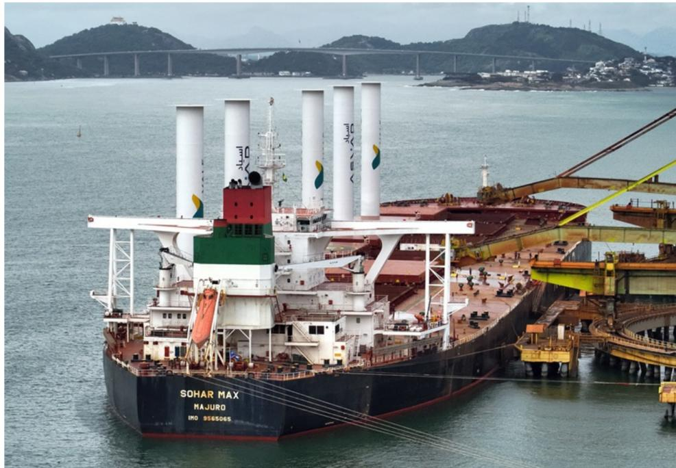
O projeto no Sohar Max é o maior piloto de velas rotativas do mundo, com cinco velas cilíndricas, cada uma com 35 metros de altura e 5 metros de diâmetro, instaladas na China
