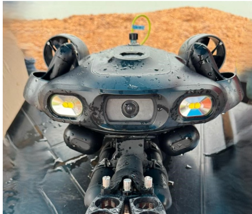
Equipado com câmeras de alta resolução, o robô submarino ROV da Petrobras e da Transpetro está auxiliando nas buscas em profundidades que variam de 20 a 60 metros
