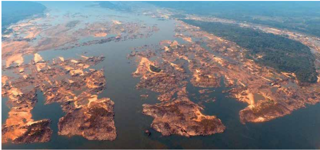
O projeto prevê o derrocamento das formações rochosas do Pedral para criar um canal de navegação que permita a passagem de embarcações de maior porte pelo rio Tocantins
