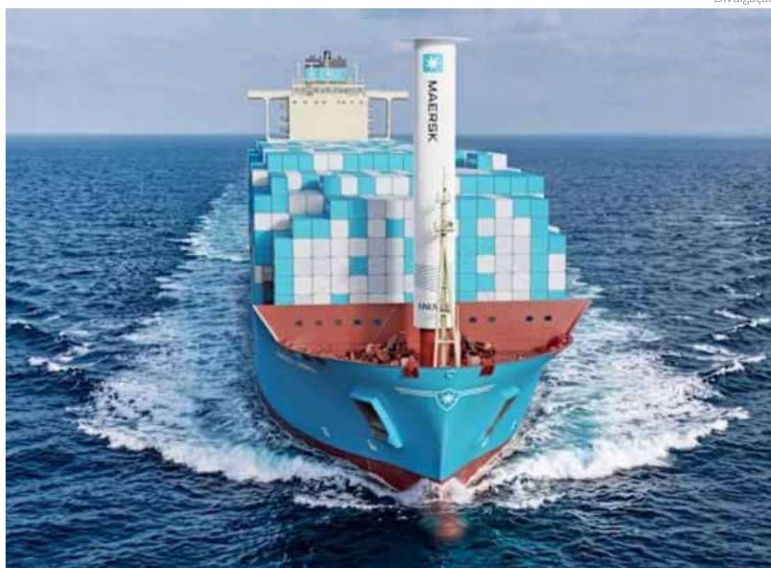
O sistema Rotor Sail utiliza um cilindro vertical que gira e, quando o vento passa por sua superfície, gera uma força aerodinâmica capaz de produzir empuxo adicional para o navio
