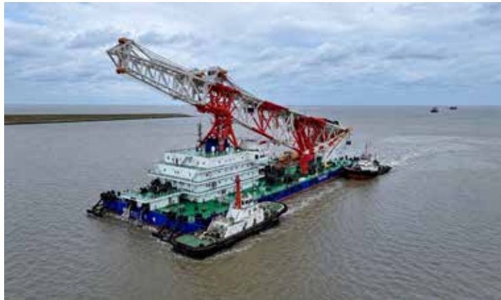
O Tiejian Daqiao Zhuang 1 também pode operar em profundidades de até 70 metros e foi projetada para trabalhos em águas profundas e áreas com condições geológicas complexas
