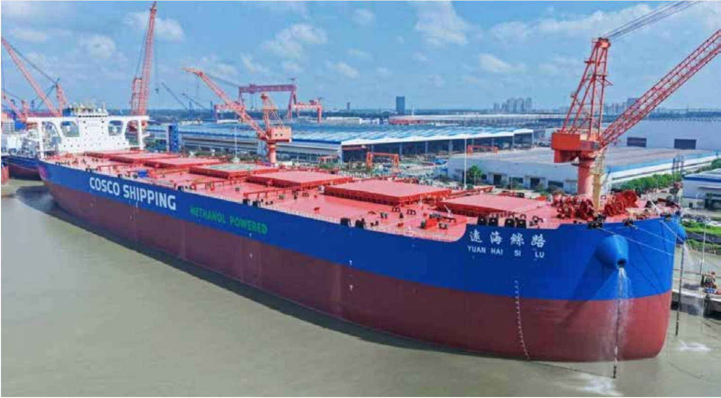
O Yuan Hai Si Lu, entregue pela Cosco, tem capacidade para 325 mil toneladas e propulsão que utiliza metanol ou combustível convencional, com autonomia de 20 mil milhas náuticas
